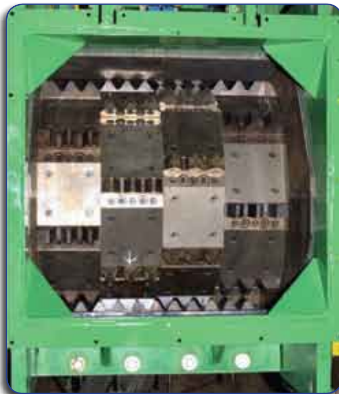
Vista interna de una Liberadora CM. Foto cortesía de Columbus McKinnon Corp
